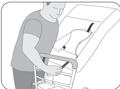
2. Commencez à enfiler le bas du coussin de dossier par-dessus la structure tubulaire de dossier. Passez les sangles dessous la partie feutrée du dessus de la structure, puis par-dessus les deux lattes du mécanisme de blocage du bercement.
