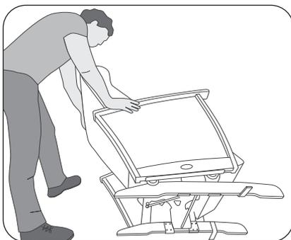
7. À l'aide d'une clé  $\frac{1}{2}$ " (13 mm), dévissez les 4 écrous hexagonaux situés sous la structure de siège, et retirez les rondelles plates et les rondelles-freins.
