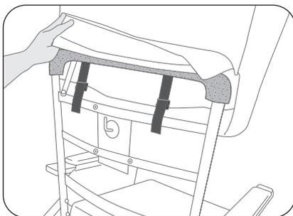
3. Continuez d'enfiler le coussin en tirant sur les sangles ou sur le rabat inférieur. Assurez-vous de passer le levier d'activation du mécanisme à travers le trou dans la housse de dossier. Si vous rencontrez de la résistance, arrêtez de tirer ; peut-être que les sangles ne sont pas enfilées correctement. Retirez le coussin et recommencez.
