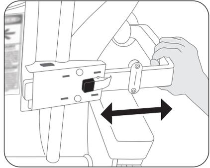
4. Resserrez les vis. Répétez la procédure sur le support opposé.
