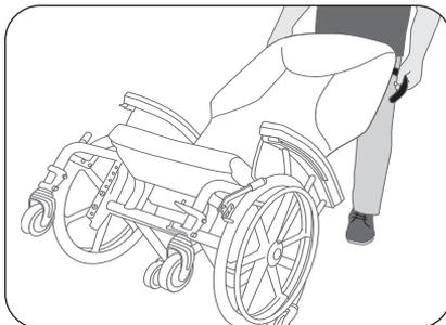
3. À l'aide d'une clé  $\frac{1}{2}$  po (13 mm), enlevez les 4 boulons (2 par côté) qui maintiennent le support du siège.
