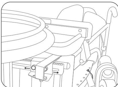
5. Lorsque la profondeur appropriée est atteinte et égale des 2 côtés, resserrer fermement les 4 boulons.
