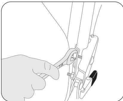
3. Positionnez les supports thoraciques à la hauteur désirée. Resserrez les écrous.
