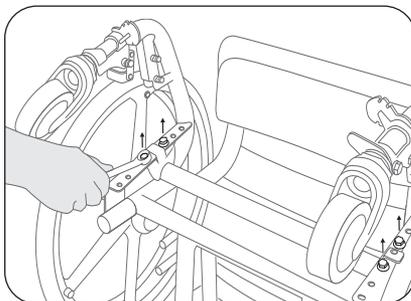
4. Positionnez le support de siège à la hauteur ciblée. ASSUREZ-VOUS QUE LES DEUX CÔTÉS SONT AU MÊME NIVEAU. Remettez les 4 boulons sans oublier les rondelles plates et les rondelles-freins. Serrez adéquatement.
