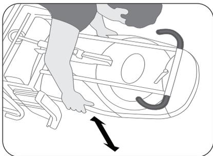
4. Lorsque la profondeur appropriée est atteinte et égale des 2 côtés, resserrer fermement les 4 boulons.
