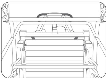
2. À l'aide d'une clé  $\frac{1}{2}$  po (13 mm), desserrez les 4 boulons sous la structure d'assise qui passent au travers des rainures et qui contrôlent la profondeur d'assise. ATTENTION : NE LES RETIREZ PAS COMPLÈTEMENT.
