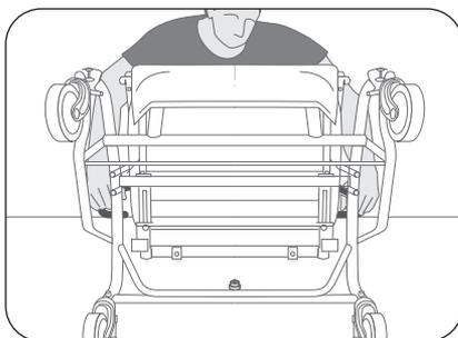
2. À l'aide d'une clé  $\frac{1}{2}$  po (13 mm), enlevez les 4 boulons (2 par côté) qui maintiennent le support du siège.
