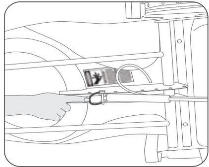
4. Repositionnez le vérin au gaz à l'endroit adéquat, puis réinstallez la goupille et sécurisez-la avec la boucle d'attache.
