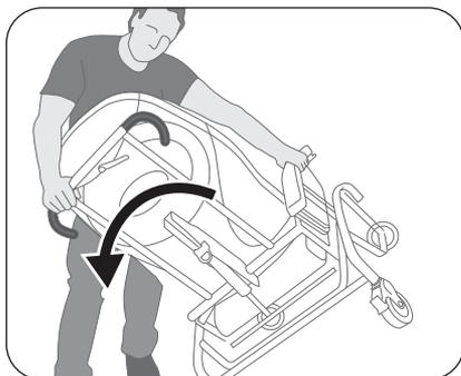
3. Sous le siège, à l'arrière du fauteuil, repérez la série de 4 trous en arc qui contrôle l'angle du dossier. À l'aide d'une clé  $\frac{1}{2}$  po (13 mm), retirez les boulons de chaque côté.
