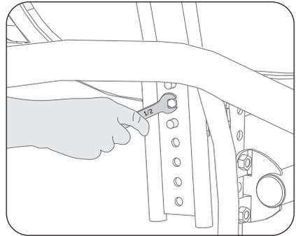
2. Placez l'appui-bras à la hauteur voulue et remettez le boulon, sans oublier la rondelle plate et la rondelle-frein.
