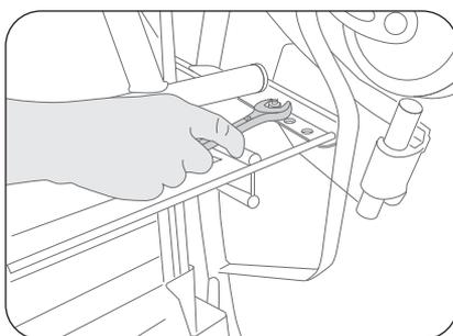
3. Positionnez le support de siège à la hauteur ciblée. ASSUREZ-VOUS QUE LES DEUX CÔTÉS SONT AU MÊME NIVEAU. Remettez les 4 boulons sans oublier les rondelles plates et les rondelles-freins. Serrez adéquatement.
