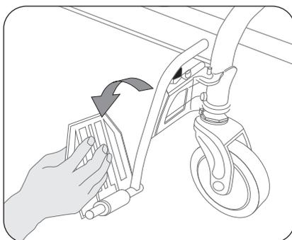
4. Pour ranger l'appui-pied, remontez la palette d'appui-pied à la verticale, actionnez le levier à capuchon noir et faites pivoter l'appui-pied vers l'extérieur, jusqu'à ce que celui-ci se verrouille.
